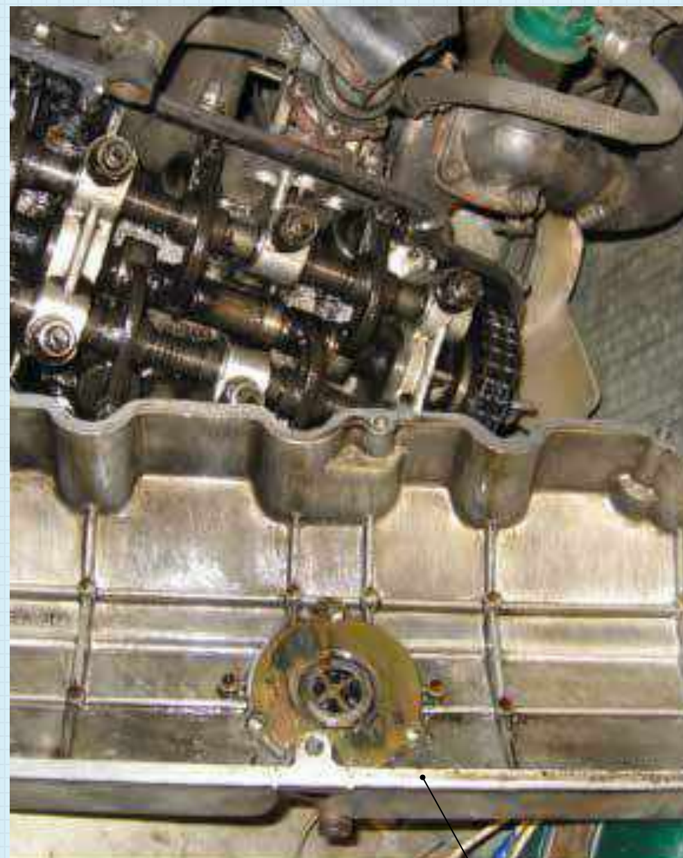
Крышка клапанного механизма отмыта полностью
