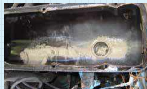
В верхней части крышки, белый налет. Корпус крышки, и все что под ней, отмыто Аевитом.
