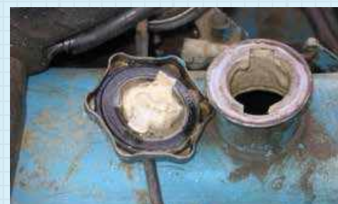
На заливной горловине и пробке белый эмульсионный налет.
