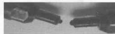
Рисунок 1 – Распылители форсунок дизеля Д 440 после работы на чистом рапсовом масле без добавления наноккомпозита.
